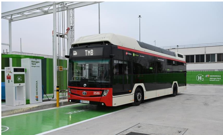
L'H2 City Gold LHD de CaetanoBus a la planta de subministrament d'Iberdrola a la Zona Franca de Barcelona
