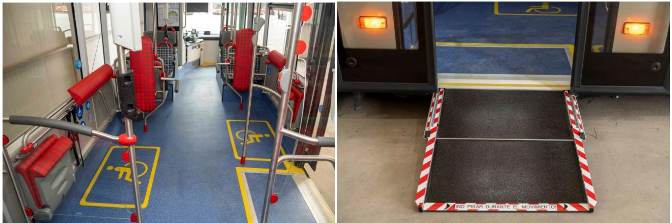
Espacios preferentes para sillas de ruedas, a ambos lados, y ajuste de la rampa y la puerta central
