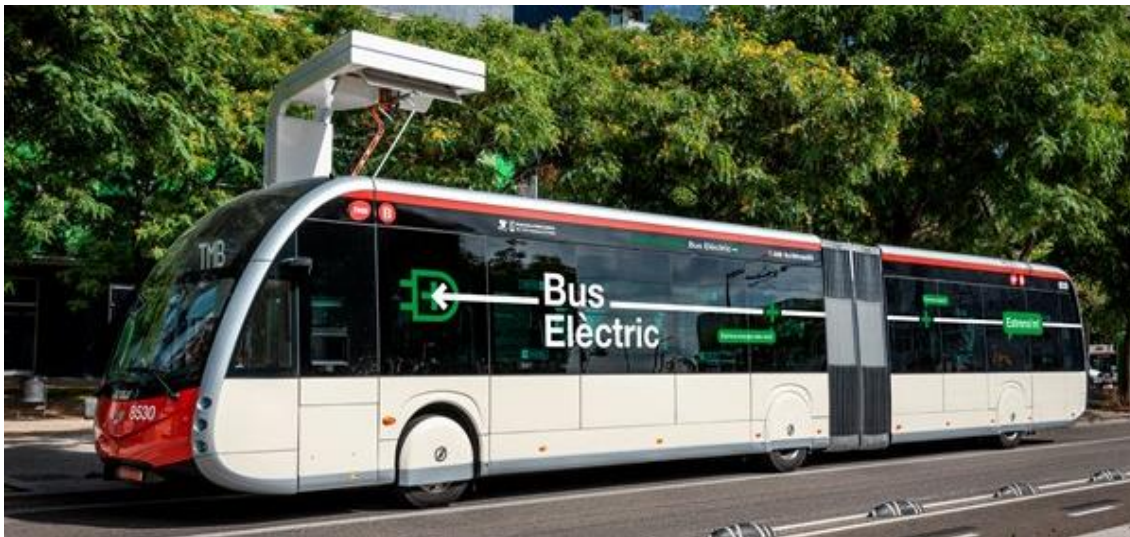
Autobús articulado eléctrico Irizar en la estación de carga del Fòrum
