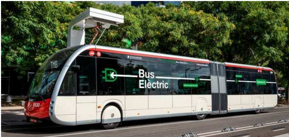
Autobús articulat elèctric Irizar a l'estació de càrrega del Fòrum
